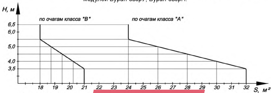
Рисунок 4.2 - Огнетушащая способность модуля Буран-8взрУ в интервале высот от 3,5 м до 5,5 м.
